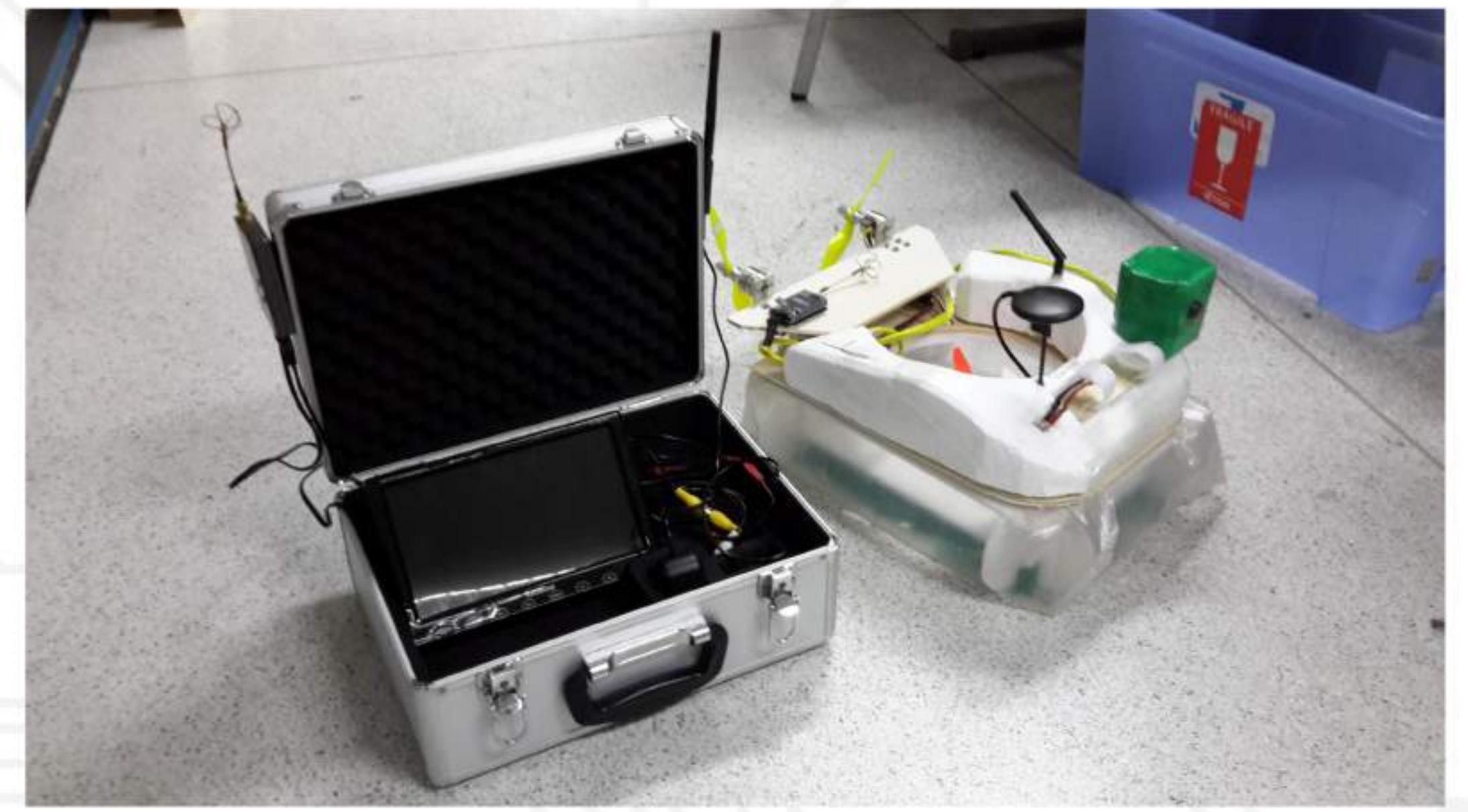
ชุด MAR พร้อมลงพื้นที่ภาคสนามเพื่อปฏิบัติการภายในห้อง Base Station ภายในติดตั้งจอภาพความคมชัดสูง เพื่อให้ท่านสามารถชมภาพจาก MAR แบบเรียลไทม์ (Realtime) มีเครื่องรับสัญญาณภาพแบบไร้สาย และ Telemetry พร้อมให้ท่านติดตั้งอย่างง่ายดาย Plug - in
